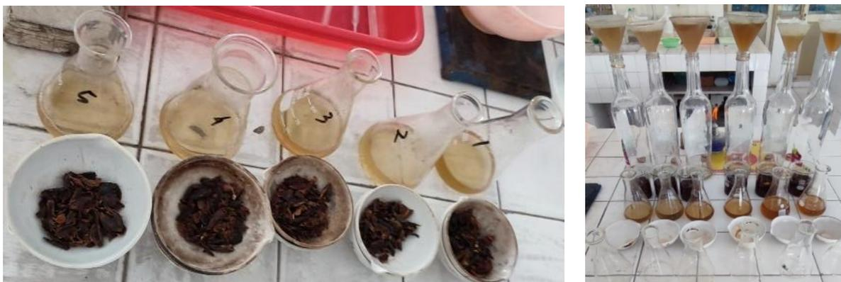
Gambar 2. Penentuan kadar air dari cascara dengan metode Thermovolumetri Bidwel Sterling
