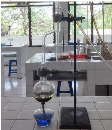
Gambar 1. Penentuan kadar air dari cascara dengan metode Thermovolumetri Bidwel Sterling
